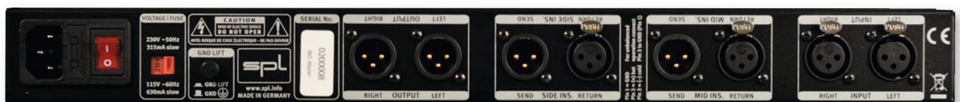
Symmetrie pur: Die Anschlüsse des M/S Master sind kompromisslos auf den Profi-Bereich ausgerichtet und in Form von XLR-Buchsen ausgelegt. Highlight sind die separaten Inserts für Mitten- und Seitenkanal zum Anschluss von Effektprozessoren. In den Inserts sowie den Ein- und Ausgangsstufen werkeln separate Operationsverstärker.
